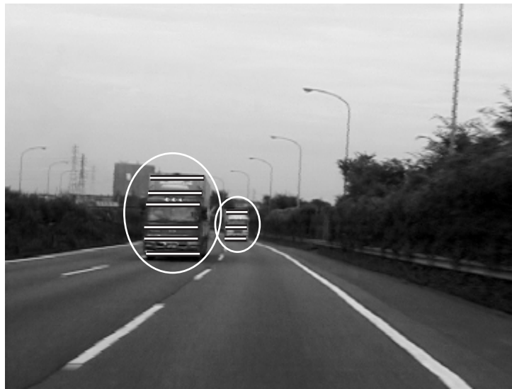
図 7.3 後方接近車両の水平エッジ成分
